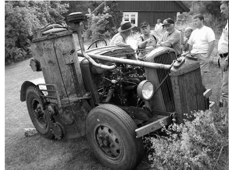
Egy fagáz üzeműre átalakított Ford traktor.
